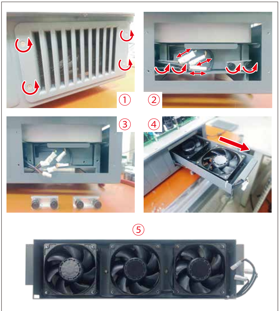
圖5-9：拆卸功率模組風扇（僅以單側為例）
