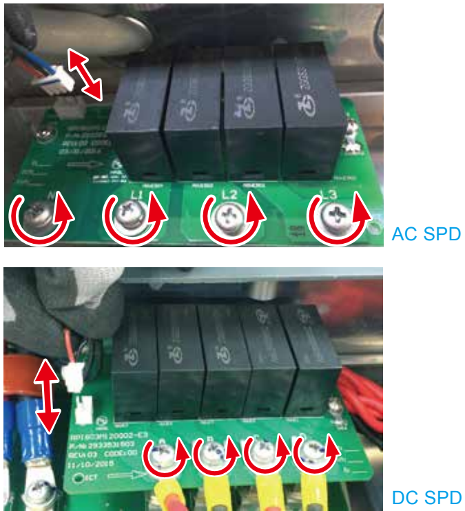
圖5-4 : 拔起連接線並移除螺絲
