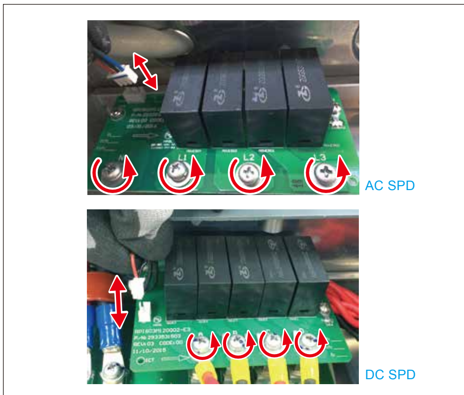
图5-4 : 拔起连接线并移除螺丝
